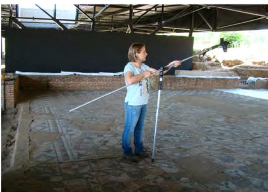
Pértiga ligera y extensible de aluminio corrugado en forma de T mediante pieza de unión inclinada y móvil para el control de la altura. Anclaje de cámara con trípode pequeño introducido y sujeto en el extremo. Desmontable para el transporte.
