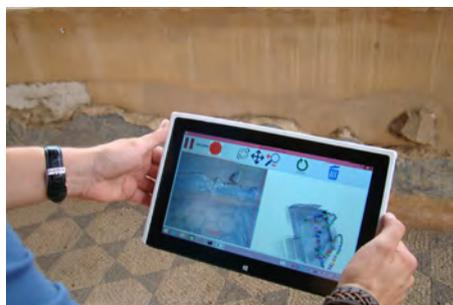
Figura 178. Detalle del uso de la tableta durante la captura de imágenes. A la izquierda se observa la imagen capturada y a la derecha el recorrido realizado.
