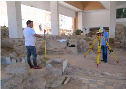
Estación total Geodimeter 422 y prisma de localización para la georreferenciación de los marcadores de puntos de control.
