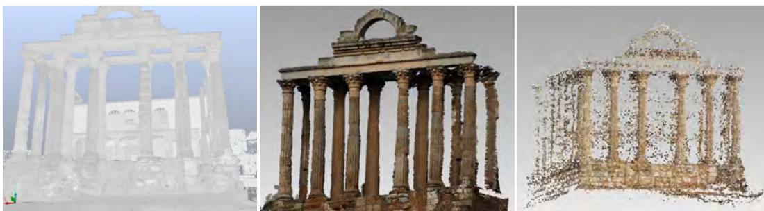
Figura 176. Comparativa de los resultados previos a edición (nube de puntos) de scanner láser, fotogrametría y videogrametría, por P. Ortiz en 2012. ORTIZ – DEL PINO 2013: 92-93.
