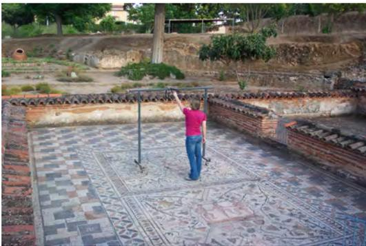
Góndola móvil de hierro, ajustable en altura y longitud, con ruedas de goma y sujeción de la cámara mediante pieza específica con tornillo de palometa. Desmontable para el transporte.
