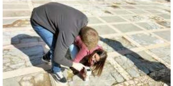
Análisis *in situ* para medir el color de la piedra antes del tratamiento de bioconsolidación. Laboratorio TESELA.
